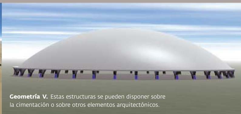
Geometría III. Elipsoides: Cuando se presentan problemas de altura o de superficie en planta.
